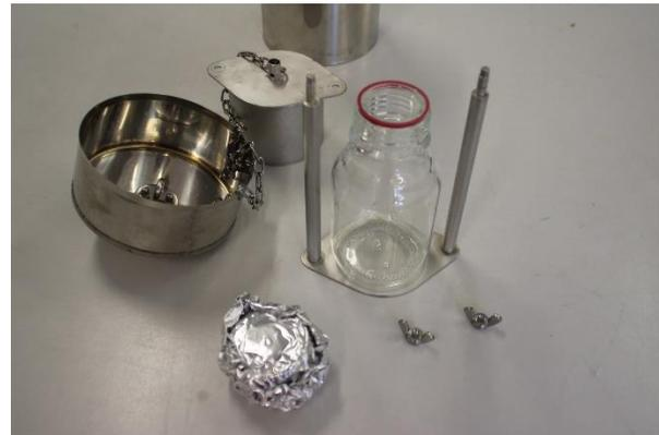
Für eine tiefengewichtete Schöpfprobe bei der Beprobung von Trinkwasserbehältern kann oben abgebildete Probennahmeverrichtung eingesetzt werden. (Probennahmeverrichtung kann vom Labor ausgeliehen werden.)
